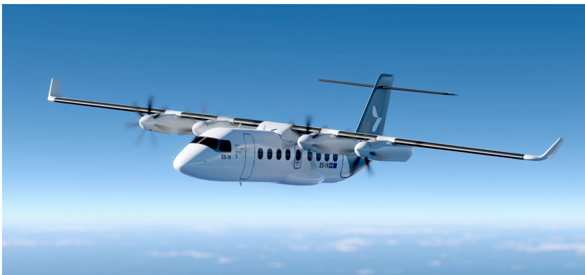
Figur 1: ES-19 frå svenske Heart Aerospace. Et 19-seters batterielektrisk passasjerfly med trykkabin som vil kunne betene de fleste FOT-rutene på Vestlandet, samt Bergen - Stavanger.
