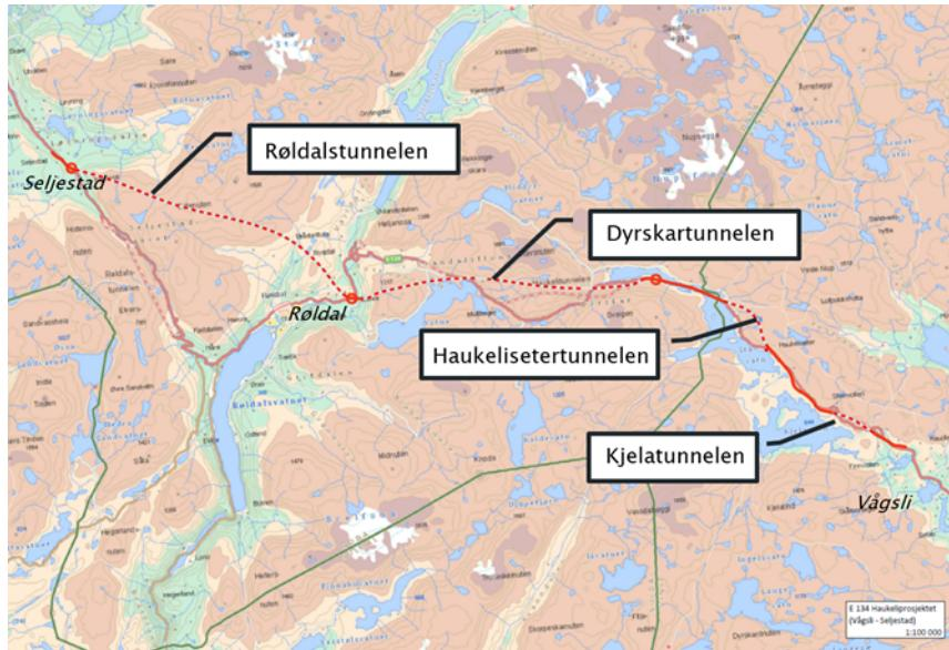
Dei to lange tunnelane er regulerte for firefelts veg med to løp. I det første byggetrinnet er det planlagt å bygge tofelts tunnelar i eitt løp. Om trafikkmengda krev det, kan E134 utvidast utan nye reguleringsplanar.
