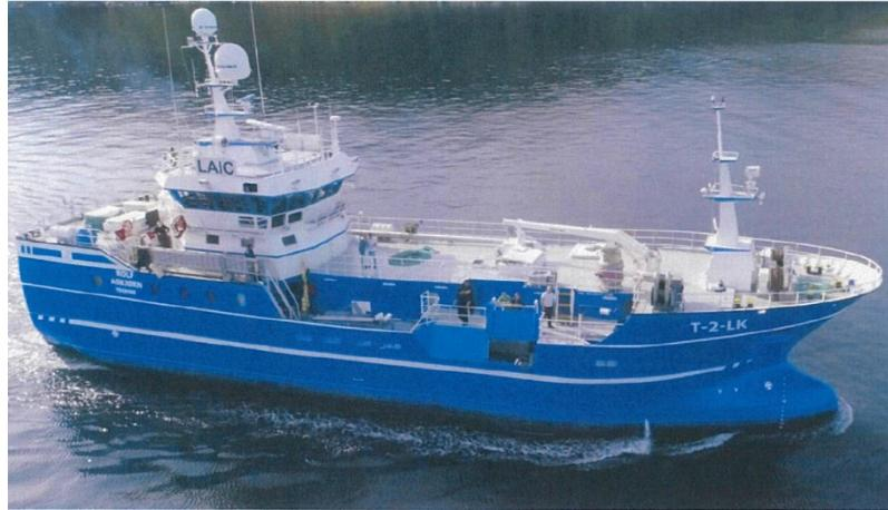
**M/S Nesejenta:** Fartøyet er 32,5 x 9m og 459 brt. Det er bygd i 2011 på Vestværftet i Danmark. Fartøyet er berre rigga for garndrift i dag og må byggast om til linefiske også. Dette fartøyet er av ca. tilsvarende størrelse som eit nedskalert nytt fartøy (500 brt) og har lugarkapasitet til 10 personar. Pris 30 mill. kr eks mva.
