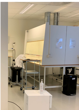
Figur 2 Arbeidsstasjon for muggsanering, med avtrekkshette
