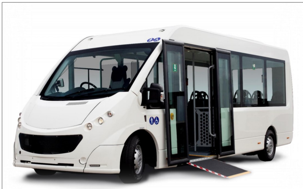
Figur 6 Eksempel på lavgulvs minibuss EVM Metro LF Super Flat Low Floor (Flynn, 2016)
