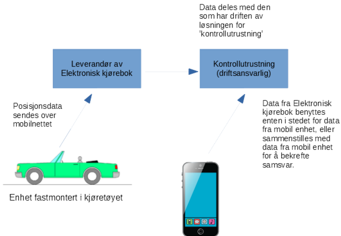
Figur 2: Skisse av potensiell løsning der GNSS-signal sikres med elektronisk kjørebok
