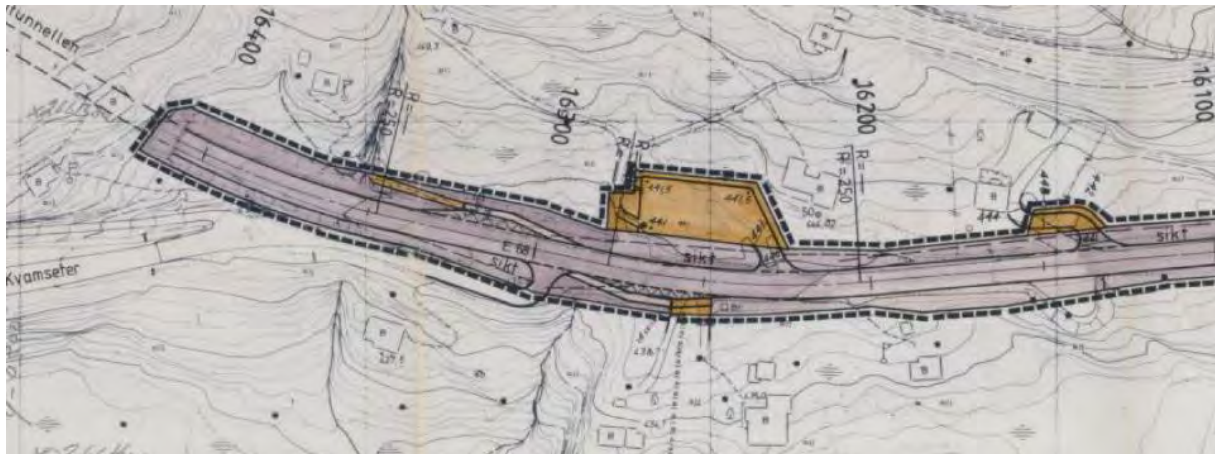
Fig. 15. ALT 1 Utsnitt frå gjeldande reguleringsplan E68 Kvamskogen, kartblad 11, tilnærma dagens situasjon for kryss på sørside av fv49 (avstand 121 m frå tunnel).
