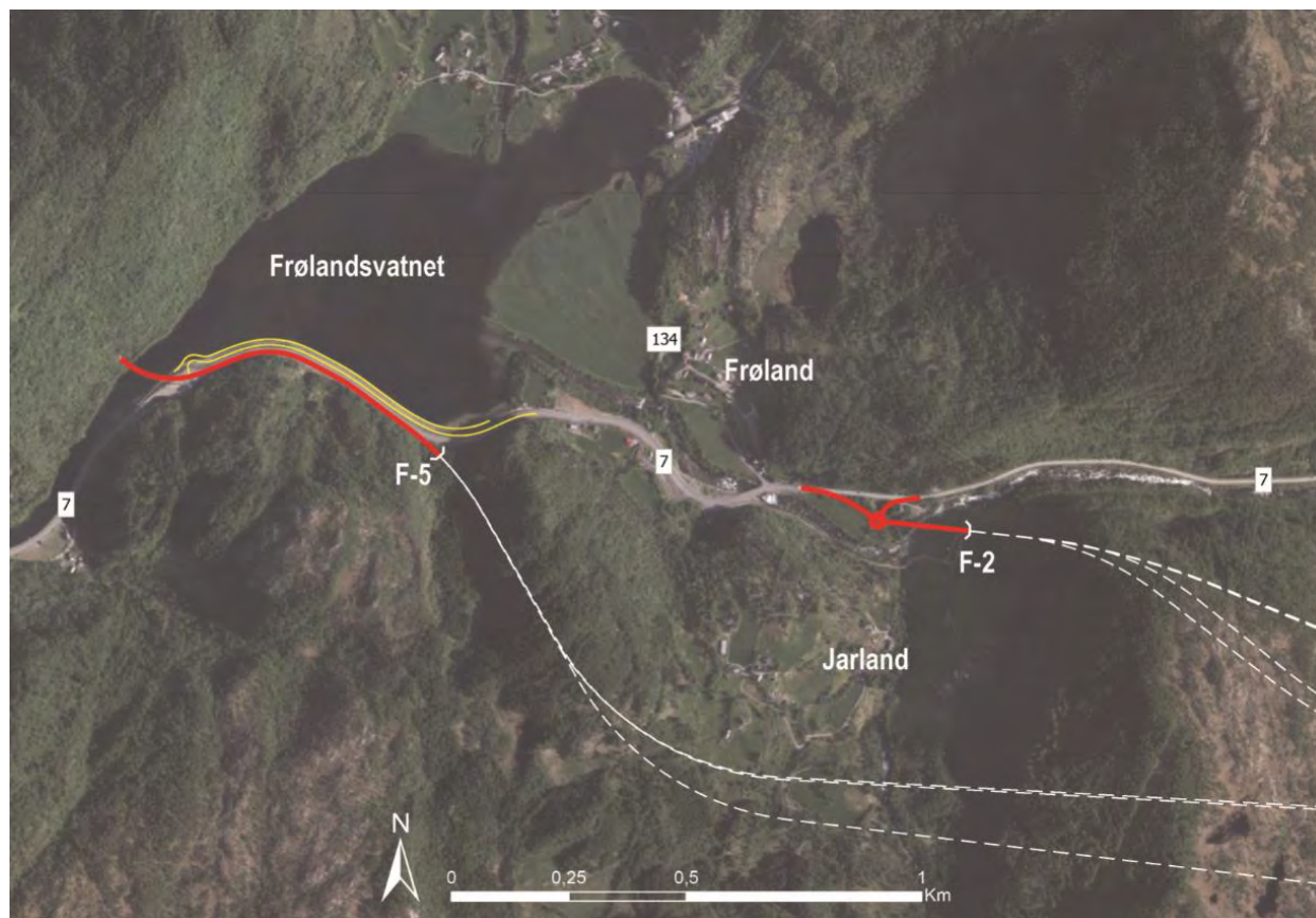
Figur 3.5 Ortofotogram som syner dei 2 alternative påhogga som er utgreidd ved Frøland, F2 Ved Jarland og F5 ved Frølandsvatnet. Det siste er forkasta undervegs i planprosessen..
