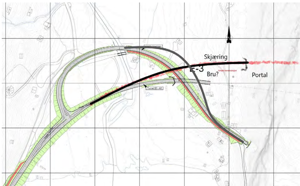
Figur 3: Endring av påhogg i Eikedalen. Svart linje viser alternativ plassering av ny veglinje for fv. 49. Lokalveg, vist med mørk grå linje, kan leggest på bru over ny fylkesveg i staden for over portal som planlagt i opprinneleg løysing.
