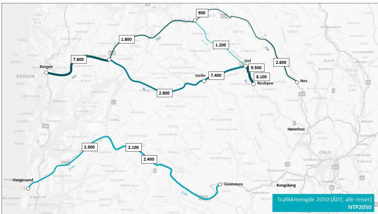
Figur 6-1: Trafikkmengde i 2050 (ÅDT, alle reiser) langs E134, E16, rv.7 og rv. 52 i Referansealternativet (NTP2050). 11
