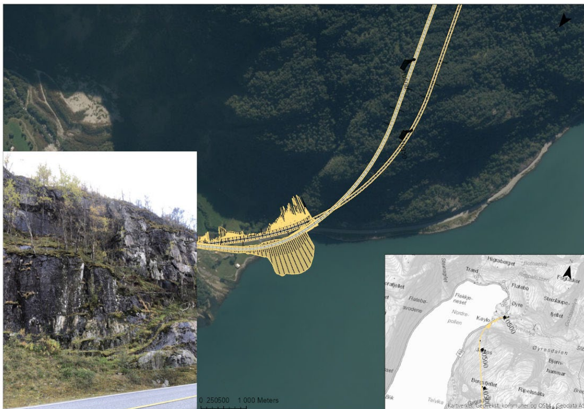
Figur 3-5: Påhugg B er einaste alternativ i Nordrepollen. Det er teikna to variantar, der det eine påhugget er vinkla meir mot fjellsida, dette medføre større fylling, delvis i sjø.
