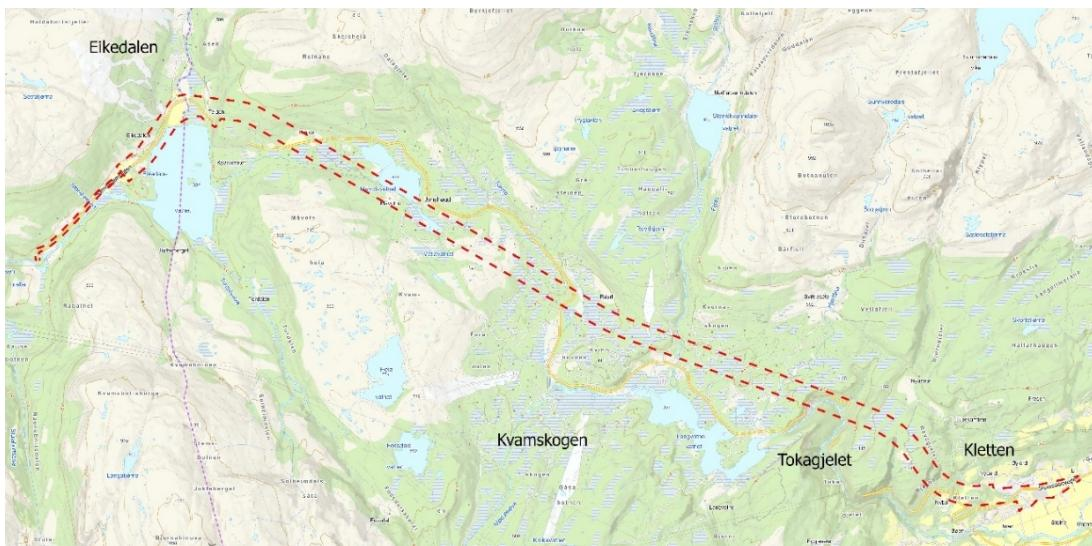
Ny veg skal dimensjonerast som vegklasse Hø1 Øvrig hovudveg, jf. handbok *N100 Veg- og gateutforming* frå 2019. Det betyr at vegen skal ha ei breidde på 7,5 meter, fartsgrense 80 km/t og at tunnelen byggjast med eit tunnelprofil på T9,5.
