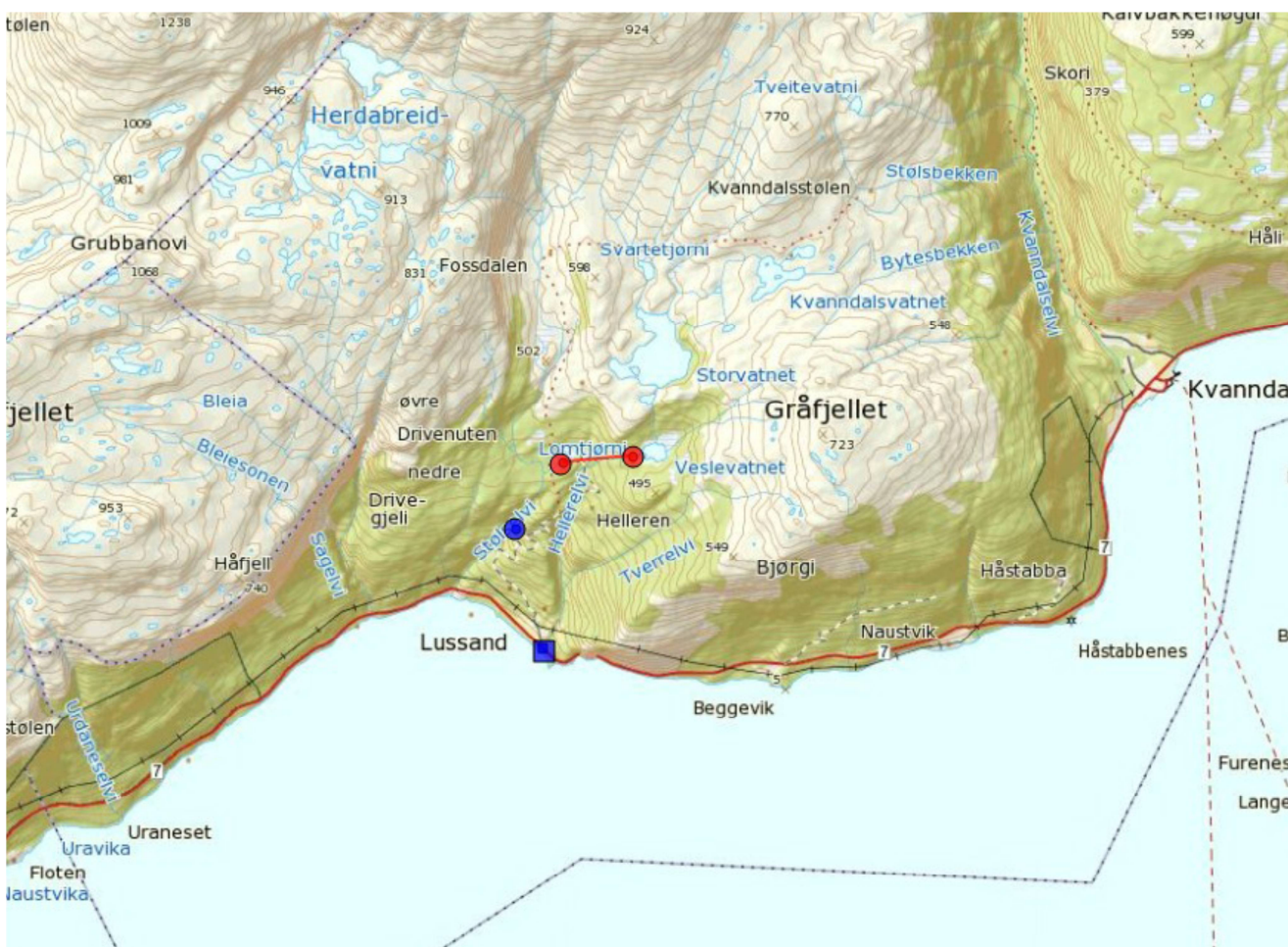
Figur 1 Raud strek syner overføring frå Hedlarelvi til Stølselvi. Blå sirkel er inntaket i Stølselvi. Blå firkant er kraftstasjon og utløp ved Hardangerfjorden.
