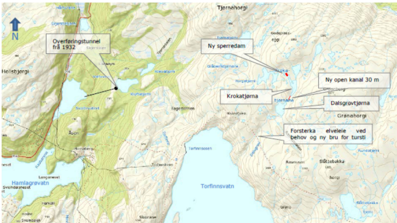
Figur 2 Dei fysiske tiltaka ved overføringa. Ein dam etablerast ved dagens utlup av Krokattjønne. Ved å fjerne ei steinrøys og grave ut ein 30 m kanal etablerast eit nytt utlup og ny vassveg til Dalsgrovtjønna (kart frå søknad).
