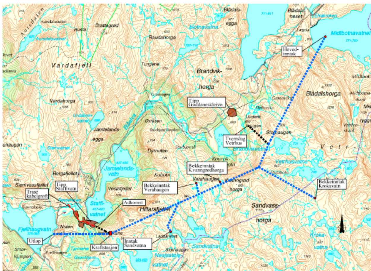
Fig. 2 Fjellhaugen kraftverk, prinsipskisse
