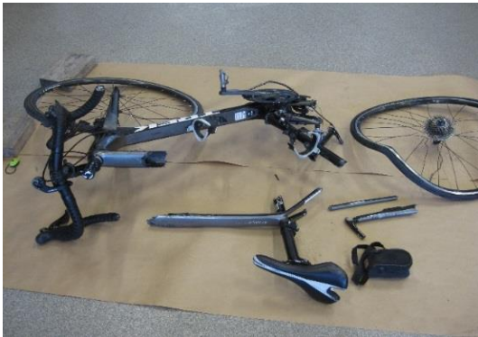
Figur 2: Sykkelrammen knakk i flere deler og bakhjulet ble deformert. Foto: SHT
