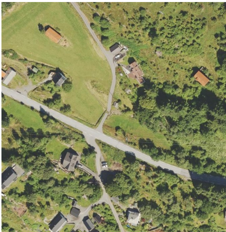
Den omsøkte avkjørsla på oppsida av Fv 562. Mangler tilfredstillende sikt i søraustleg retning.
