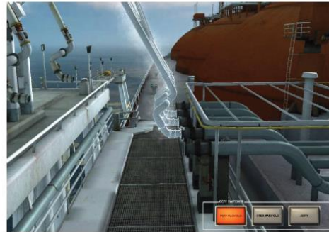
Cold loading arms on the LNG tanker
