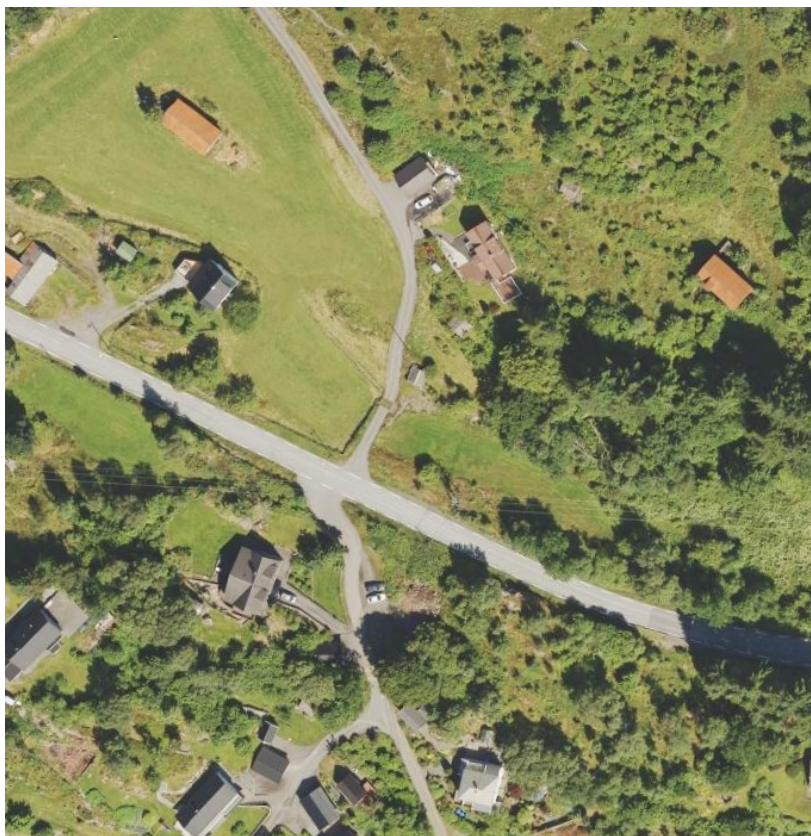
Den omsøkte avkjørsla på oppsida av Fv 562. Mangler tilfredstillande sikt i søraustleg retning.
