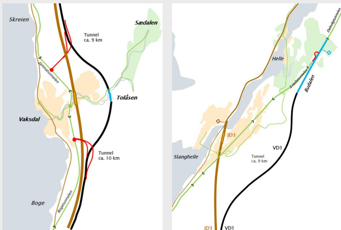
Figur 21: Prinsipp for ny veg og bane forbi Vaksdal og Stanghelle Jernbane med brun strek, E16 med svart strek (tunnel) og blå strek (dagsone). Raud strek syner kryssrampar i tunnel. Dagens veg syner med tynn grøn og brun linje
