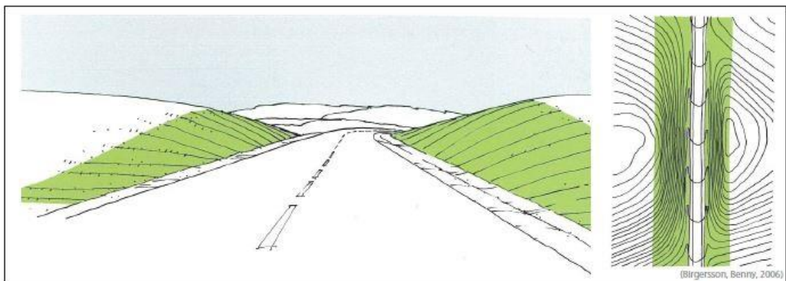
Figur 8-24: Skissa viser korleis annan veggrunn kan utformast for å gi ein naturleg overgang frå veg til landskap. Kjelde: Birgersson, Benny / Formingsrettleiar
