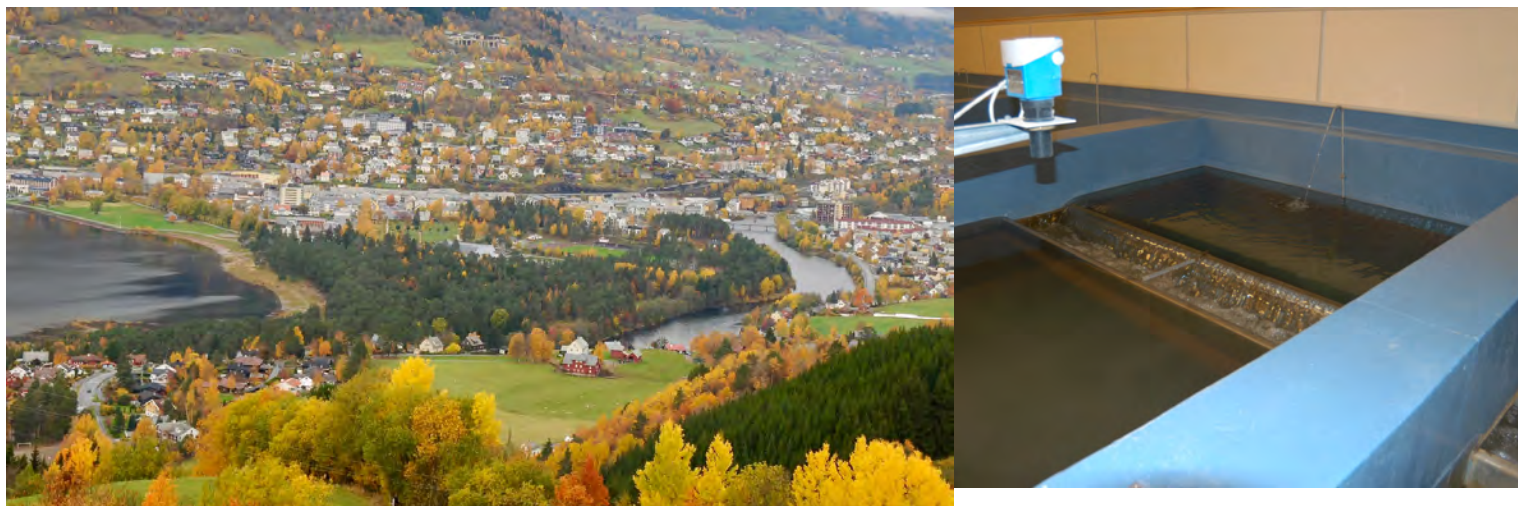
Figur 3 Vossevangen vassverk med kjemikaliefri behandling med filtrering av vatnet i marmolfilter og deretter UV-bestråling. Vatnet vert teke inn frå lausmassar i elva Vosso og Vangsvatnet. Dette er ei av Noregs sine beste drikkevasskjelder og forsynet vatn til ca 10 000 personar.
