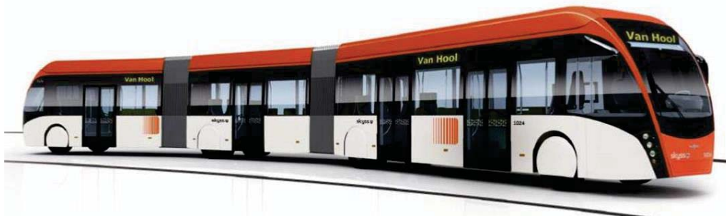
Figur 11 Bergen prøver ein no ut elektriske bussar som får ström fra ein eigen biogassmotor. Dette skal følgjast opp med eit måleprogram i samarbeid med Høgskulen i Bergen
