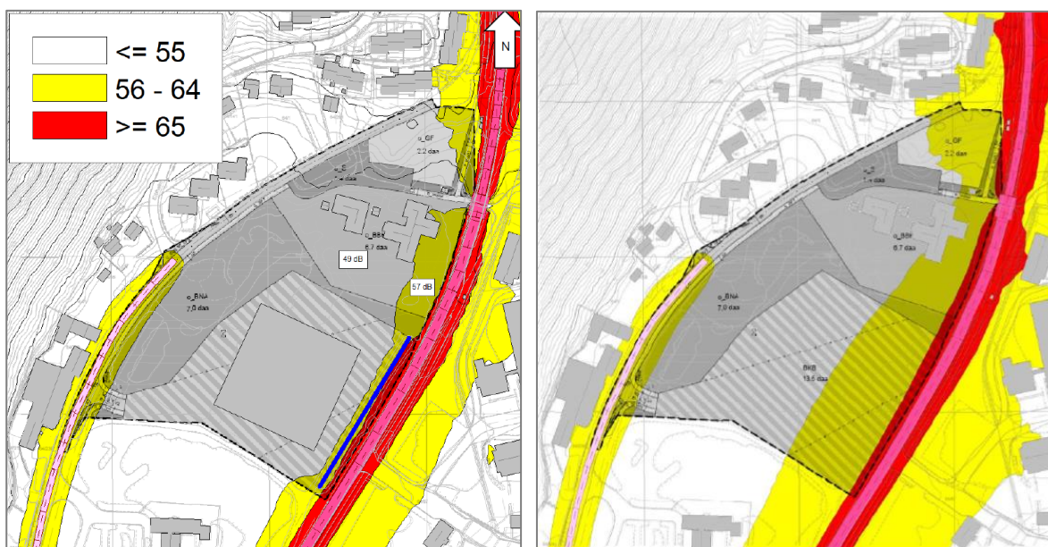
Figur 16. Støyutbredelse L_d (dB) på planområdet. Venstre, 1,5 m over terreng. Blå linje viser eksisterande voll mot Fv550. Grå boks viser mogleg plassering av nytt næringsbygg. Høgre: 4m over terreng og utan jordvoll mot Fv550.
