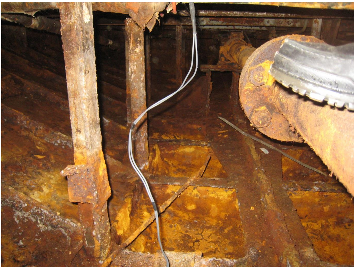
Bunnstokkar og aksling under dørken i mannskapsinnreiinga 15.12.2014. Bunnvatn er tørka ut ved hjelp av avfuktarar.
