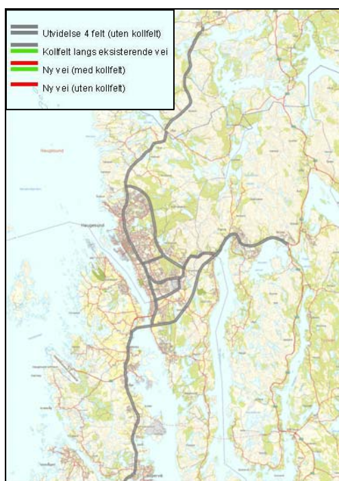
Figur 7.10. Prinsipp-modell for transportutvikling i konsept 1: Vegbasert/spredt. Fire-felts veier er angitt med dobbel strek i figuren.
