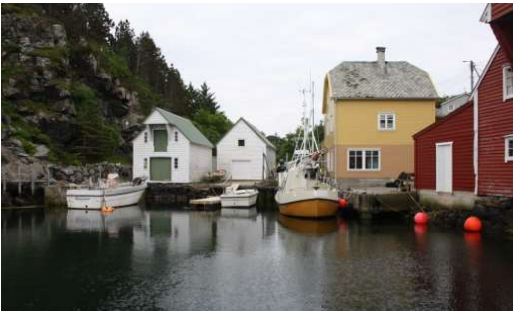
Figur 19. I dette sjøbruksmiljøet frå Stolmen, ser ein dei klassiske sjøhusa som ikkje var bygde for å huse båten men for lasting og lossing av varer og reisskap. Desse sjøhusa har utstikkande gavl med vindehjul for lossing og lasting.
