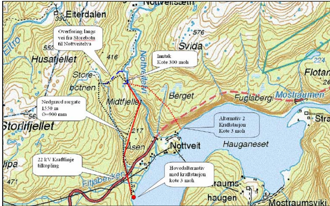
Figur 2. Utbyggingsplan for Nottveit kraftverk i Modalen kommune. Korrigerte data for nedgravd rørgate skal være 1 820 m og rørdiameter 950 mm. I tillegg er det aktuelt å regulere Øvre Setervatnet (783 moh.) nordøst i nedbørfeltet med til sammen 1,5 m.
