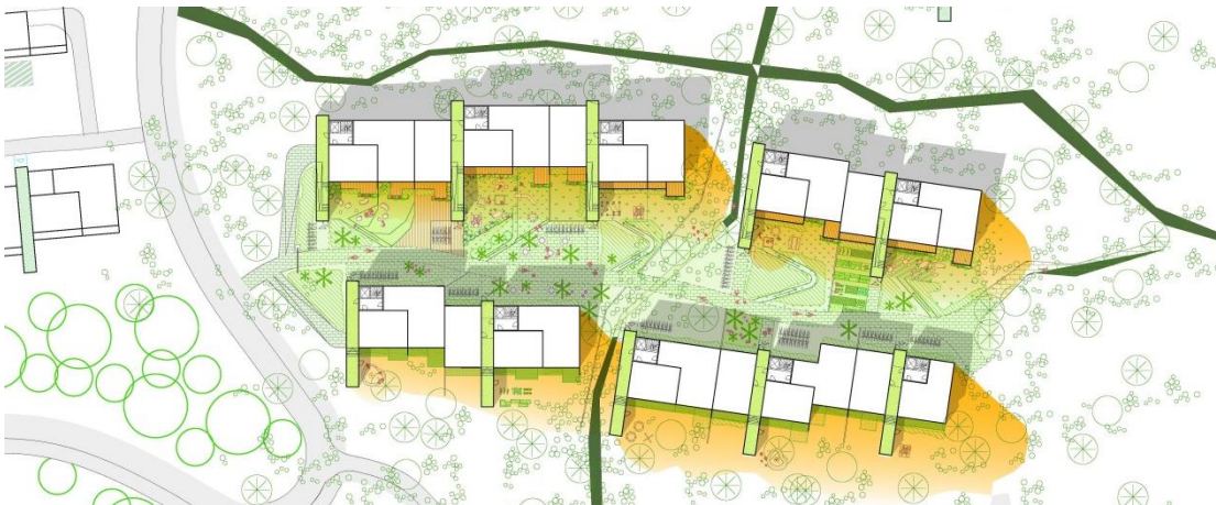
Figur 8 Eksempel på typiske Ådlandstun – orange farge indikerer støydempede utearealer/grå felt angir skygge 21/6 kl 12
