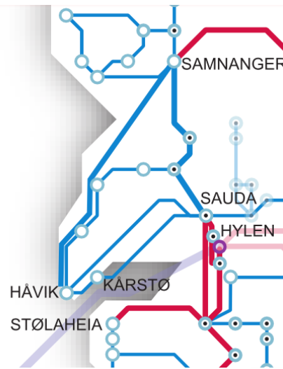
Figur 27: SKL-ringen med ny ledning fra BKK-området. Tykke streker markerer duplex/triplex. Røde streker markerer 420 kV drift.
