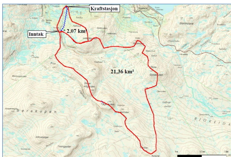
Fig. 2 Nedbørfeltet til planlagt tiltak og restfelt Drøllstølsbekken
