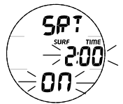
Fig. 45 - SET SRT ALARM
