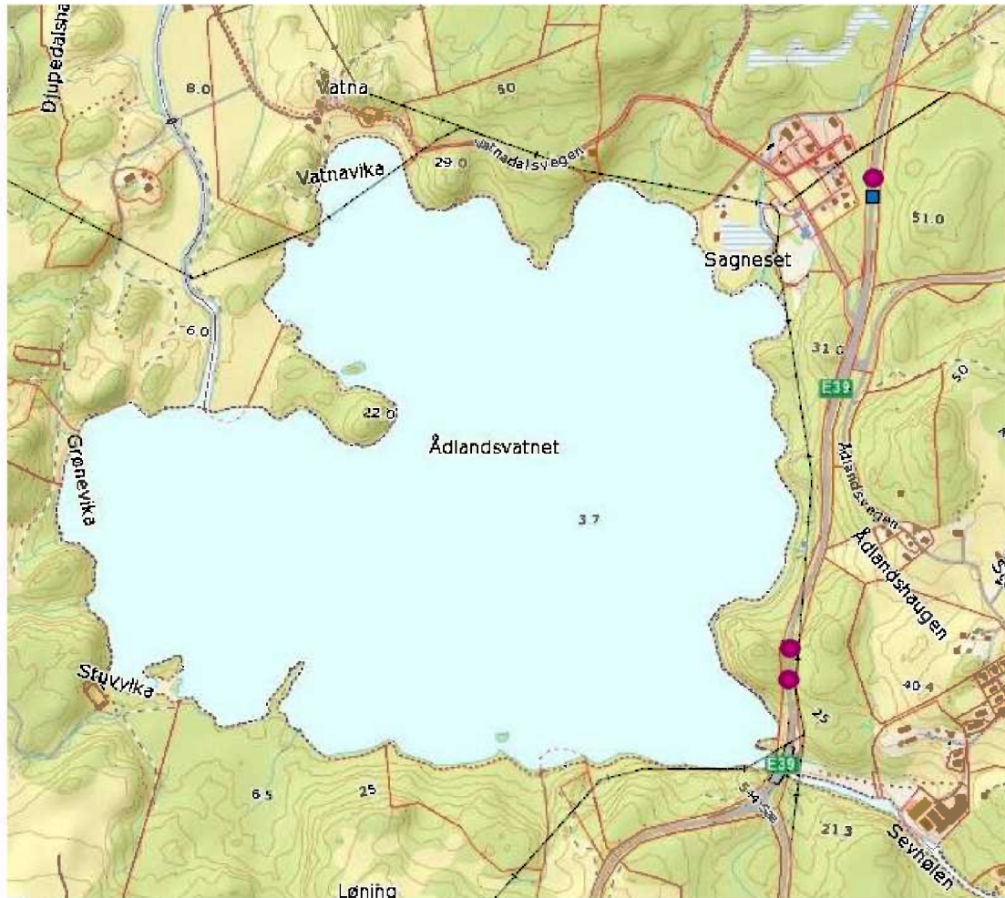
Figur 15: Registrerte steinskred i planområdet. Lilla sirkel representerer steinskred, blå firkant representerer nedfall av is (Kjelde: DSBs kart)
