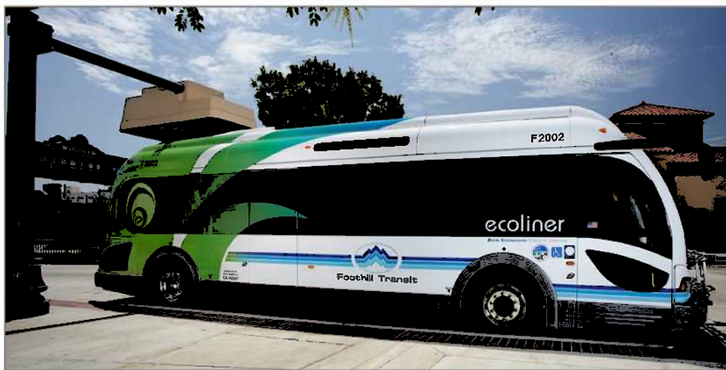
Figur 7. Eksempel fra USA med batteribuss med hurtiglading på holdeplass.
