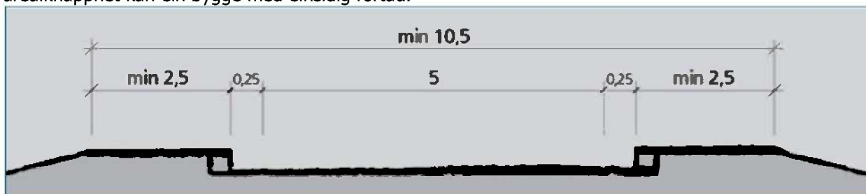
Figur 5: Tverrprofil for vegklasse Sa1 ved ÅDT < 1.500 og fartsgrense 50km/t, inkl. fortau (figur C.15 i handbok N100)
