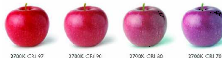
2700K CRI 97 2700K CRI 90 2700K CRI 80 2700K CRI 70 Samme fargetemperatur, men med ulik fargegjengivelse
