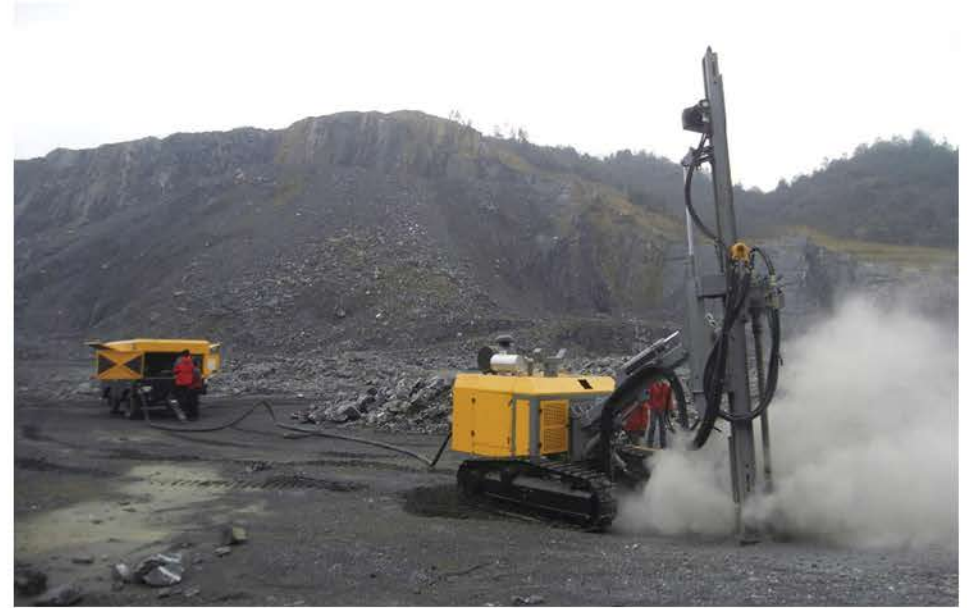
Borrmaskin för kärnbörning (ref. STYRUD AB).
