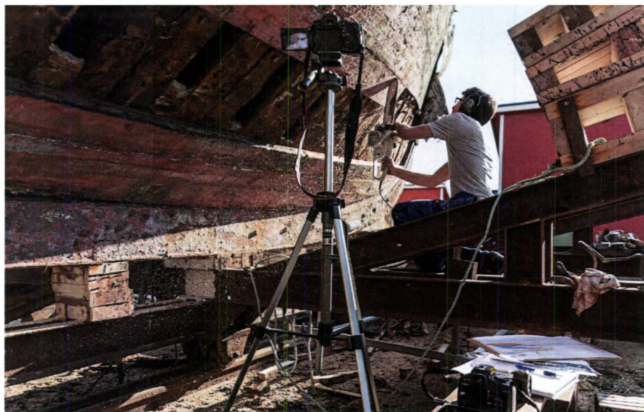
Prosessene dokumenteres underveis, og det er mange måter å dokumentere på. Her filmer Maurizio mens han river hudplank på «MS Grytøy». Still-kamera, skisseblokk, støtplan og eldre fotografier er også tilgjengelig NNFA.
