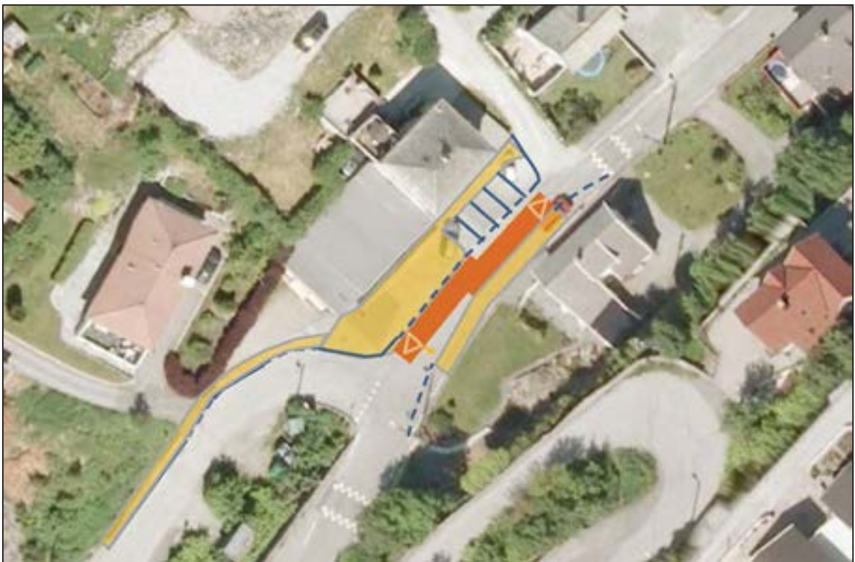
Alt 2: Salhusvegen x Vikavegen. Fortau og vanlig parkering ved frisøren. Fotgjengerrepos ved holdeplassen
