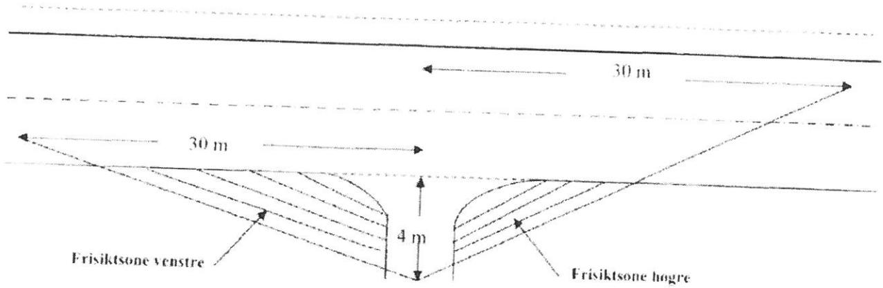
Tilsvarende siktlengder som vist på tegningen må også gjelde for trafikken som kjem på hovedvegen og skal inn i avkjørsla (sikt bakover og framover langs hovedvegen)
