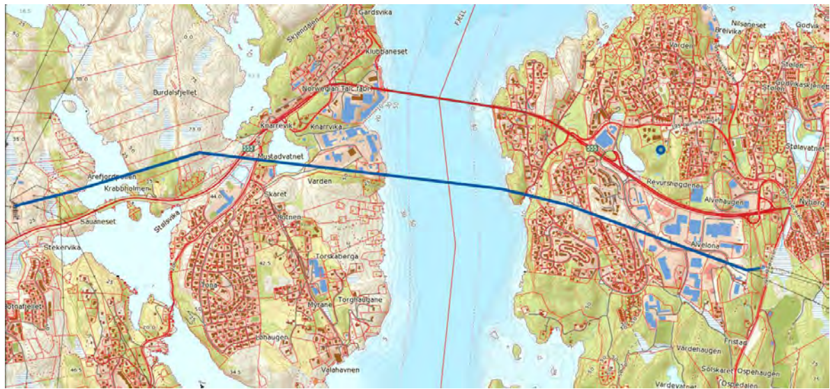
Figur 8.1 Eksisterande luftspenn frå Bergen kommune til Fjell kommune (teikna med blå farge på kartet)
