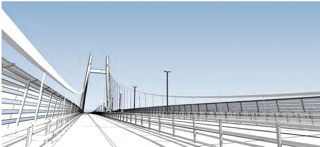
Figur 9.43, Gangbane med variant av rekkverk og støyskjerm.
