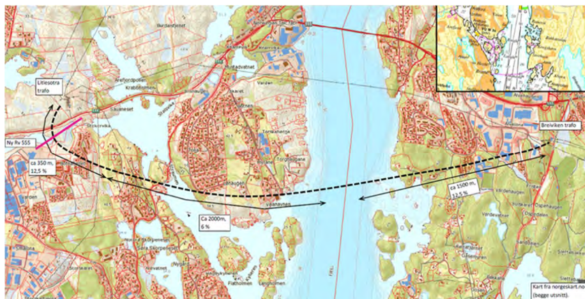
Figur 8.3 Aktuell trasé i lang tunnel
