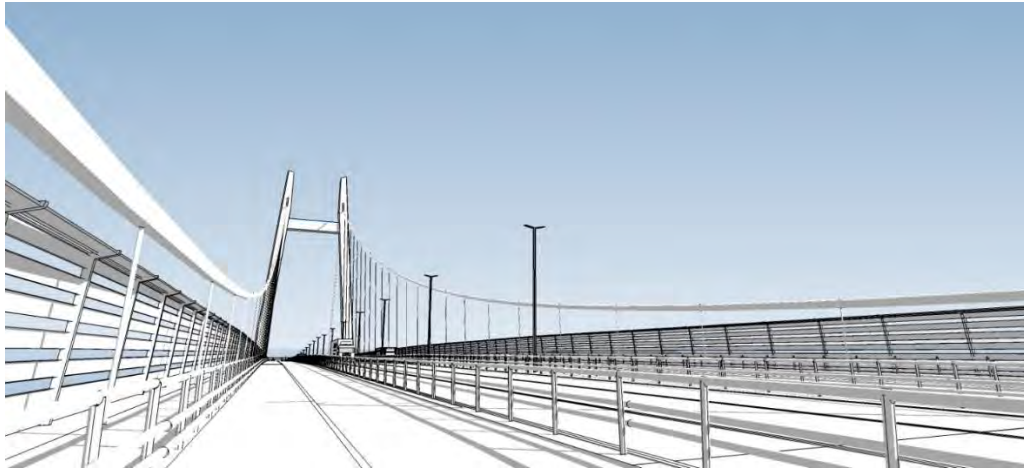
Figur 9.43, Gangbane med variant av rekkverk og støyskjerm.
