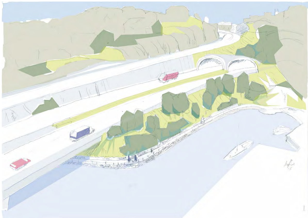
Figur 9.17 Illustrasjonssnitt som viser småbåthamn og gangveg i fyllingsfoten, Straumsundet, frå vest
