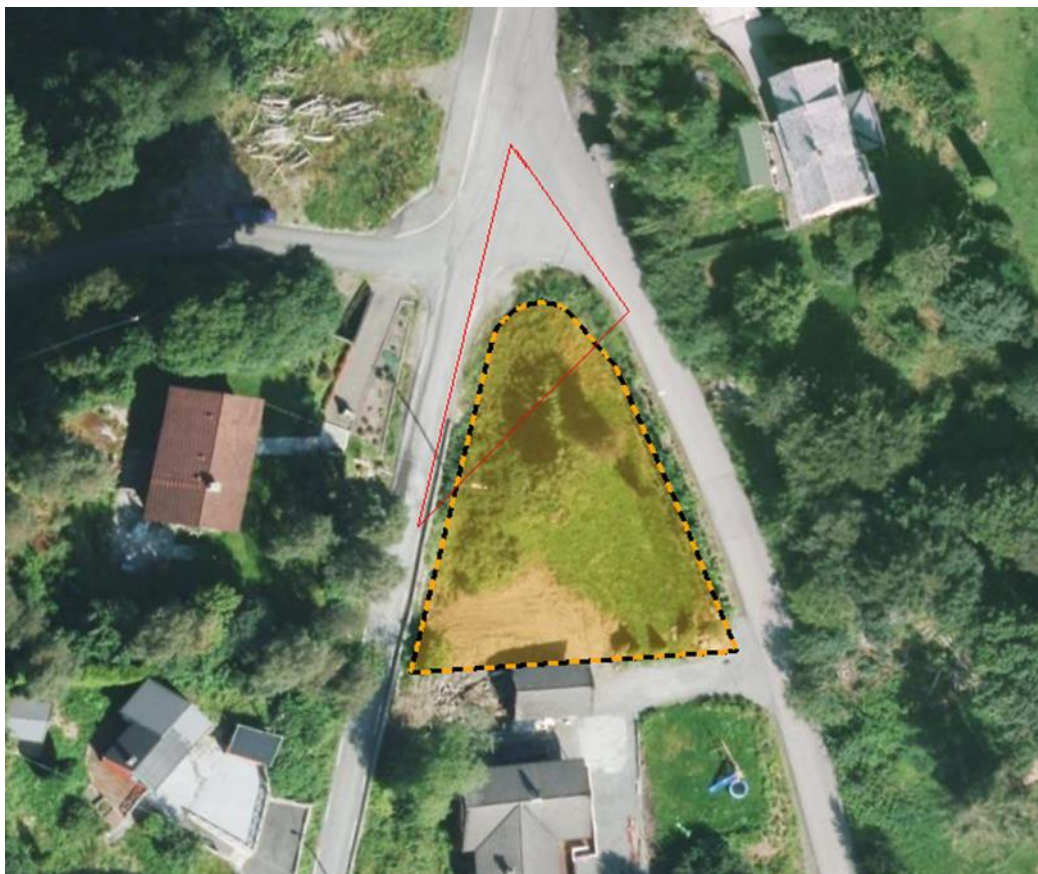
Figur 1 Dagens kryss Fv. 233, Hp1 km 1,053 er utflytende og tilfredsstillende ikke krav til teknisk utforming jfr. Håndbok N100. Rød linje illustrerer dagens krav til friskt i 40 sone.
