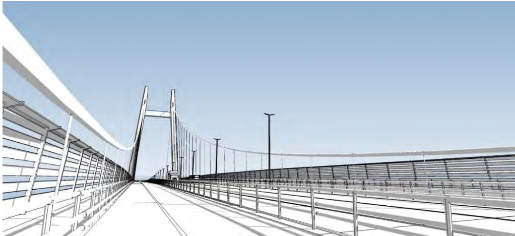
Figur 9.43, Gangbane med variant av rekkverk og støyskjerm.
