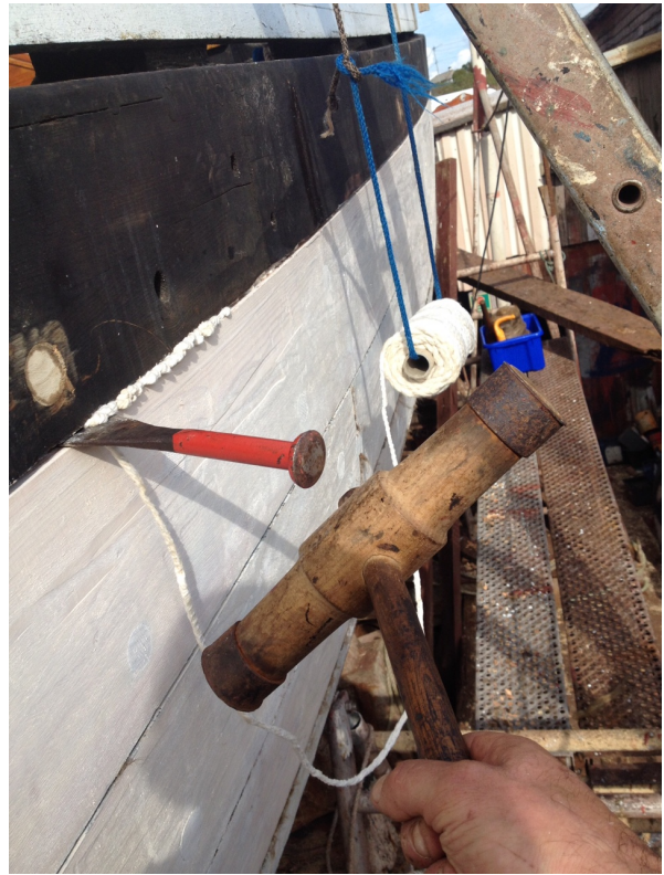
Det ble drevet med premium tjæredrev nederst og bomull lenger oppe.
