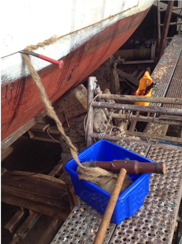
Det ble drevet med premium tjæredrev nederst og bomull lenger oppe.
