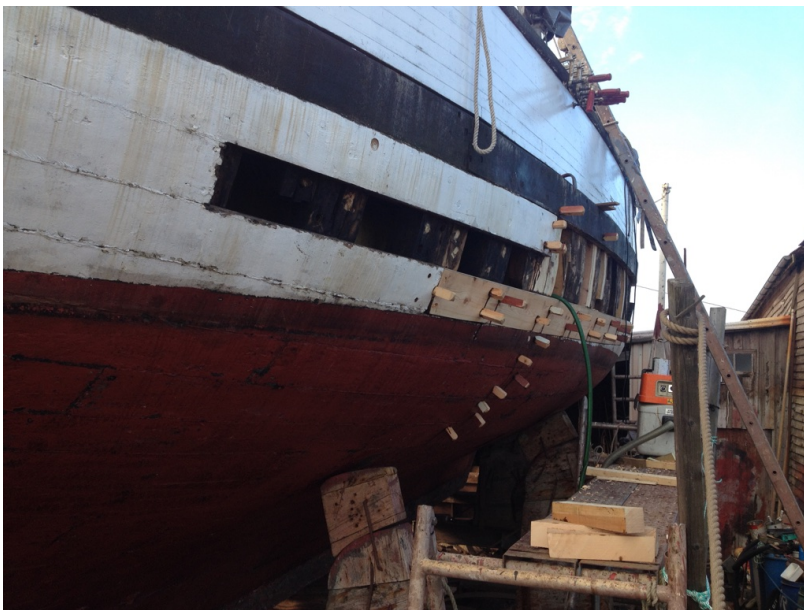
Her er det første nye bordet kommet på plass. Også det nye dobbeltspantet viser litt på bildet, men naglehodene viser hvor langt ned det går.
