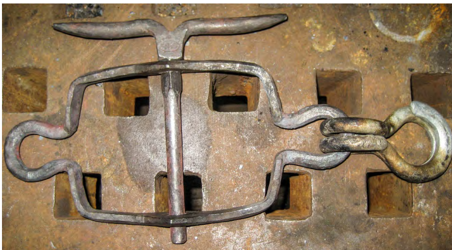
Smidde, fremfor sveiste beslag gjør en forskjell. Her et utvendig blokkbeslag. HFS.
