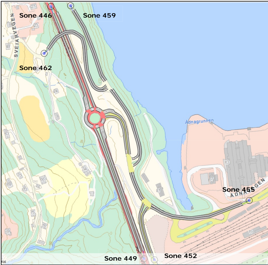
Figur 5: Lenker og soner med sonetilknytninger brukt i 'selectlink' analyse i DOM Bergen
