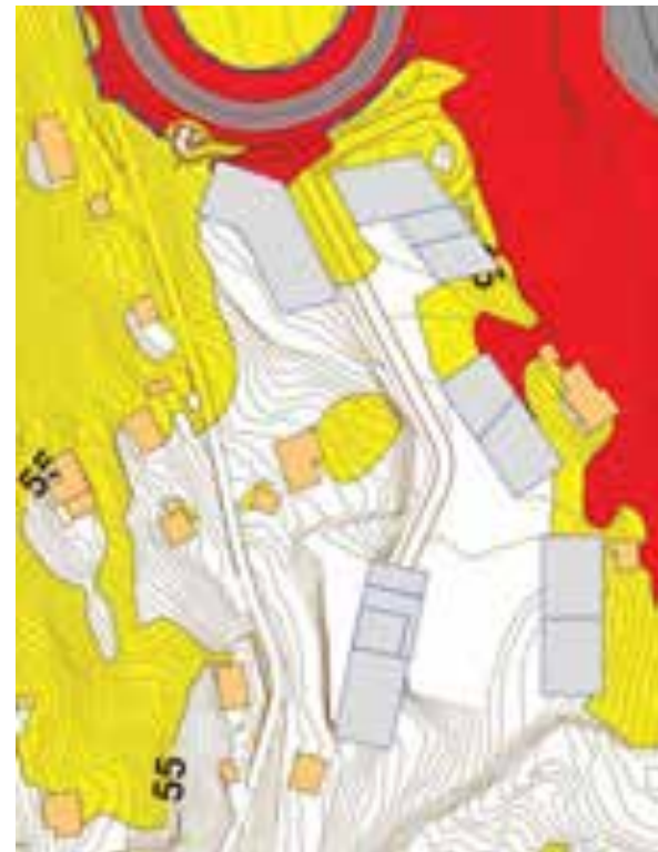
Figur 8.6.5: Etablering av støyskjerming sikrer noe bedre støyforhold for BBB1a og BBB1b
