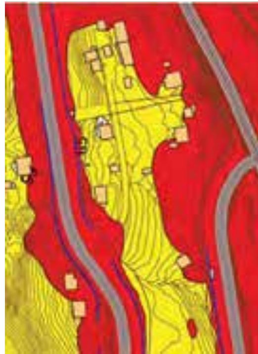
Figur 8.6.3: Fremtidig situasjon med støyskjerming for eksisterende boliger på Mjeldheim, 4 meter over terreng
