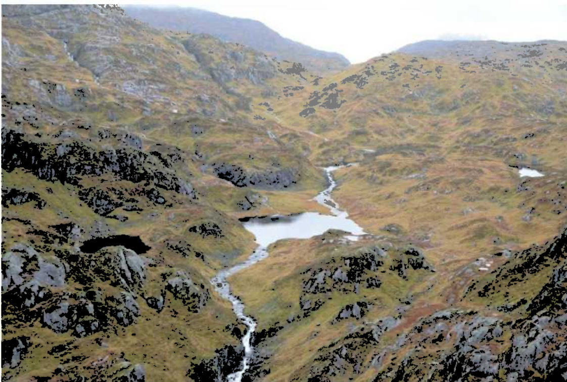
Figur 4.5. Inntak Kvanngørðhorga. Det er planlagt ein ca. 2–3 m høg sperredam like nedstraums utløpet av vatnet. Inntaket skal plasserast på ein eigna stad, avhengig av grunnforholda og plassbehovet.
