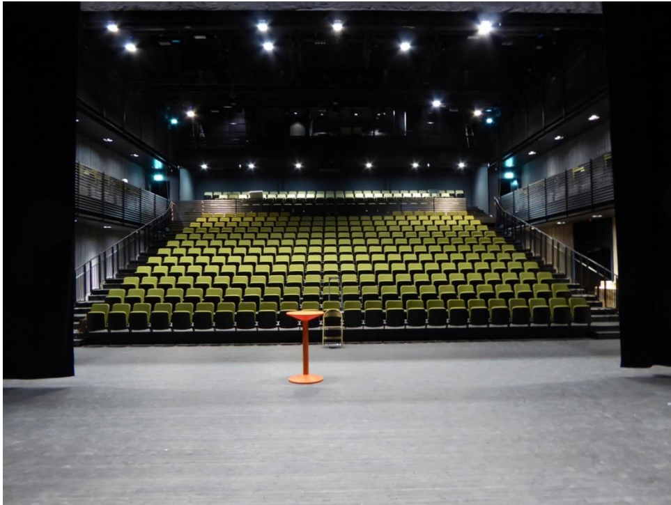
Figur D.4.1.3 Exempel på teleskoptribun
