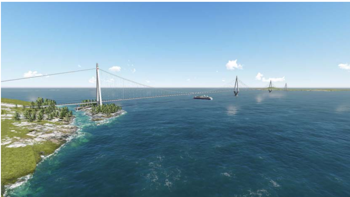
Figur 28 Fleirspenna hengebru med tårn på flytarar
